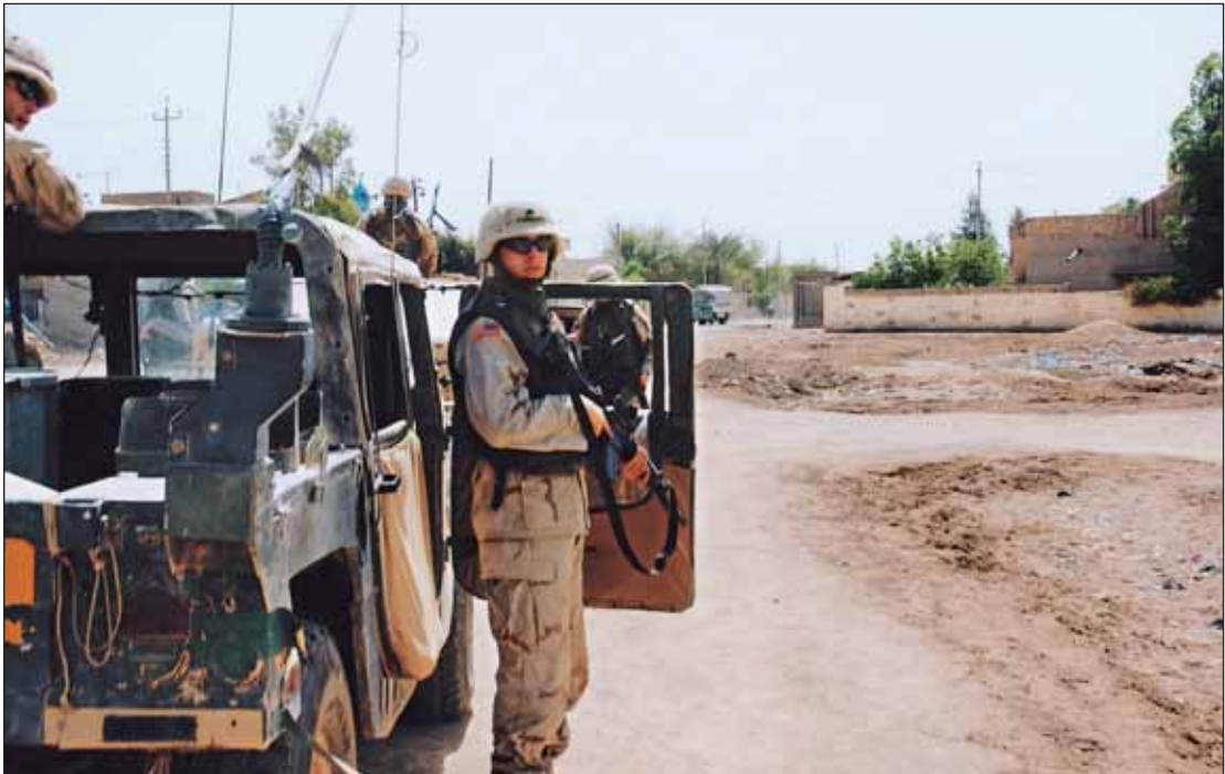
Vozidla HMMWV s vylepšeným pancéřováním (UAH) byla natolik vzácná, že vojáci začali improvizovat při vylepšování ochrany, často prostým zavěšením pytlů se zasunutými Kevlarovými pláty z vest a vozidel na jinak tenké kryté dveře vozidel Humvee.
